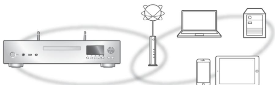
Este aparato se puede conectar a un router mediante un cable de red LAN o Wi-Fi® integrada. Para realizar una conexión estable a la red, se recomienda usar una conexión de red LAN con cable.
